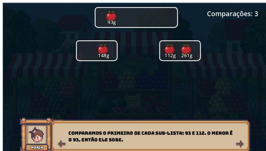
Figura 5.41: Etapa final da fase de conquista do Merge Sort : Maria compara os primeiros itens de cada grupo. A fruta de 93g é transferida para a lista ordenada primeiro, dado que seu valor é inferior ao de 112g.
